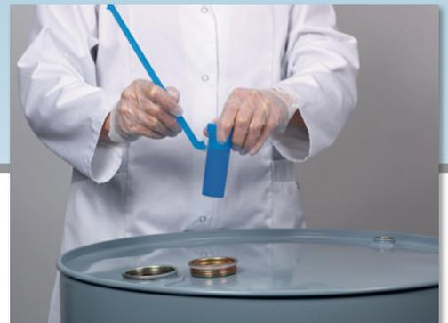
Der DispoDipper ist komplett in einem Stück gefertigt und ermöglicht die Probenahme und den anschließenden Transport der Probe in einem Gerät. Auf diese Weise ist eine Cross-Kontamination oder Verunreinigung der Probe nahezu ausgeschlossen. Nach der Probenahme kann der Griff an der Sollbruchstelle von der Probendose abgetrennt werden. Dies ermöglicht einen einfachen und platzsparenden Transport der Proben.
